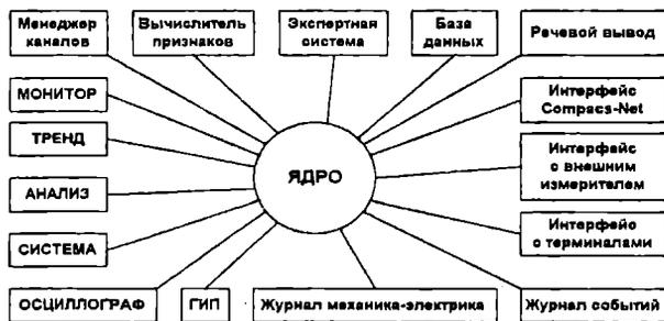
Рис. 2. Состав программного обеспечения КОМПАКС.
